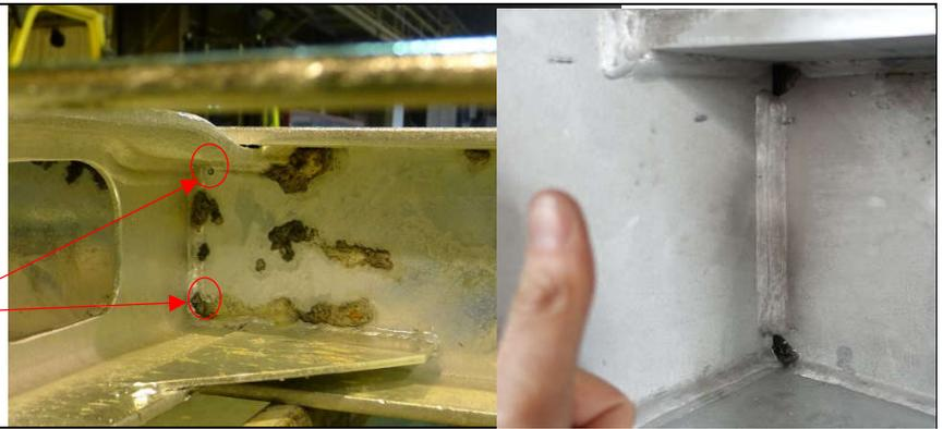
Bei **inneren Verstärkungen / Rippen** von Rohren sollten die 4 Ecken um mindestens  $\frac{1}{6}$  der Seite ausgeklinkt werden (mindestens 10 mm). Falls Ausklinkungen dieser Größe nicht möglich sind, können kleinere Ausklinkungen (mind. 10 mm) angebracht werden, welche durch eine zusätzliche grosszügige Öffnung im Blech ergänzt werden.
