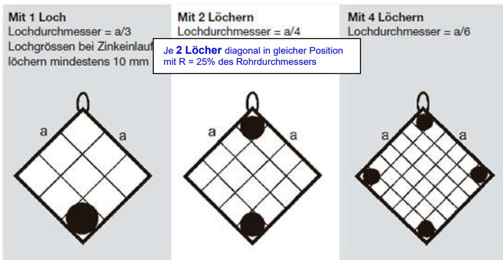
Beispiel: 50x50 mm: 1 Loch mit 16 mm oder 2 Löcher mit 12 mm oder 4 Löcher mit 8 mm
