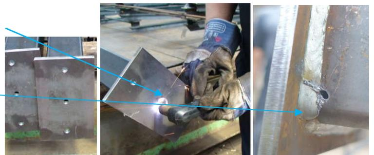
**Zu kleine Löcher** führen zum langsamen Ein- und Auslaufen des Zinks und dadurch zu langen Tauchzeiten mit dicken und oftmals unregelmässigen, unästhetischen Oberflächen. Unregelmässige Oberfläche aufgrund langer Tauchzeit
