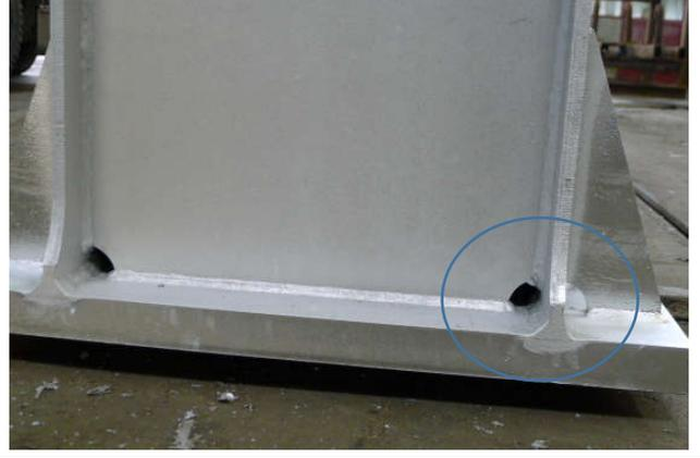
Mögliche, nicht optimale Lösung mit durchgehenden Schweissnähten. (Schweissnaht nicht optimal)
