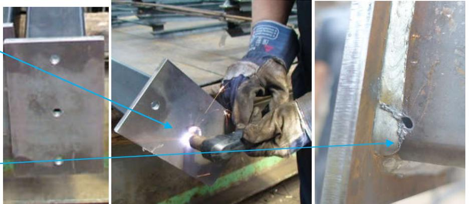
**Des trous trop petits** conduisent à une lente entrée et sortie du zinc et donc à de longs temps d'immersion avec des surfaces épaisses et souvent irrégulières et inesthétiques. Surface irrégulière en raison du long temps d'immersion
