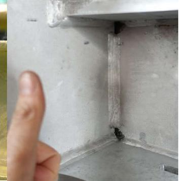
Dans le cas de **renforts / nervures internes** de tuyaux, les 4 coins doivent être entaillés d'au moins  $\frac{1}{6}$  du côté (au moins 10 mm). Si des encoches de cette taille ne sont pas possibles, des encoches plus petites (min. 10 mm) sont réalisées, et sont complétées par une grande ouverture supplémentaire dans la tôle.
