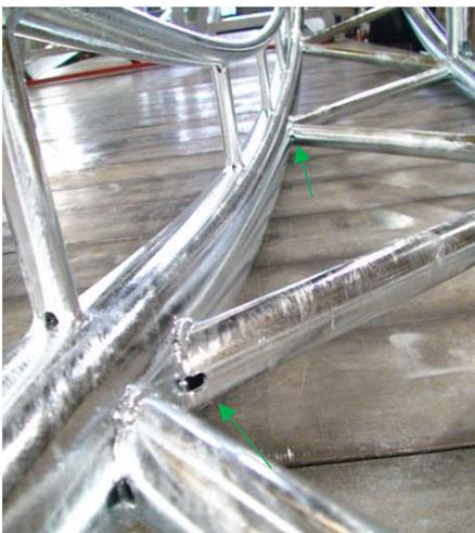
Trous d'écoulement en zinc au point le plus bas :
