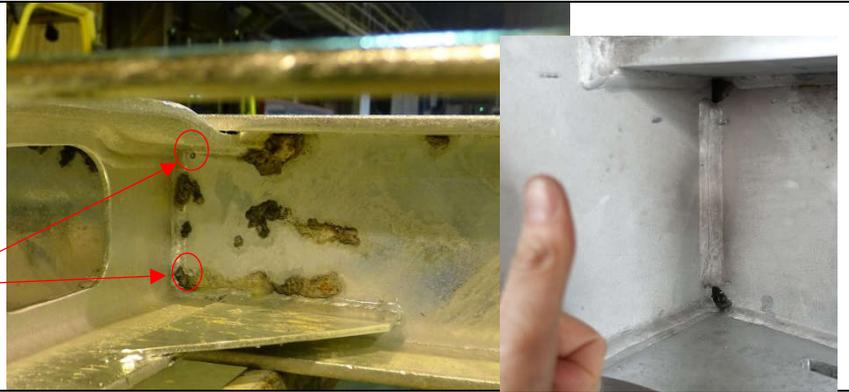
Bei **inneren Verstärkungen / Rippen** von Rohren sollten die 4 Ecken um mindestens  $\frac{1}{6}$  der Seite ausgeklinkt werden (mindestens 10 mm). Falls Ausklinkungen dieser Grösse nicht möglich sind, können kleinere Ausklinkungen (mind. 10 mm) angebracht werden, welche durch eine zusätzliche grosszügige Öffnung im Blech ergänzt werden.
